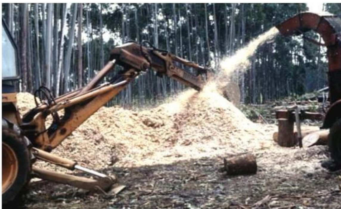
Рисунок 6.2. Приготовление древесной щепы рубительной машиной
